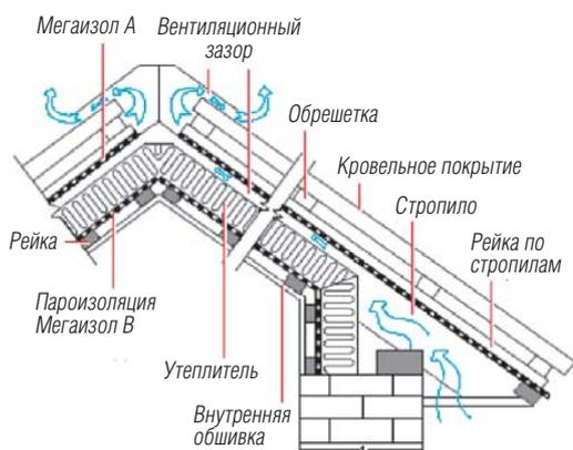
**В ЗДАНИЯХ С НАРУЖНЫМ УТЕПЛЕНИЕМ СТЕН И В УТЕПЛЕННЫХ КРОВЛЯХ** пароизоляция «Мегайзол В» **укладывается** с внутренней стороны утеплителя на элементы несущего каркаса (стойки, балки, стропила) или по черновой обшивке при помощи оцинкованных гвоздей или строительного степлера. Укладка пароизоляции **производится с плотным прилеганием гладкой стороной к утеплителю**.
