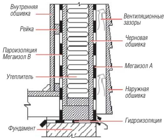
**В ЗДАНИЯХ С НАРУЖНЫМ УТЕПЛЕНИЕМ СТЕН** пароизоляция «Мегайзол В» укладывается непосредственно на внутренней поверхности стены шероховатой стороной внутрь помещения. Для установки пароизоляции на кирпичной или блочной стене применяется соединительная лента. Затем материал закрепляется контррейками или оцинкованными профилями, на которые устанавливается внутренняя обшивка (вагонка, декоративные панели, гипсокартон и т.д.).
